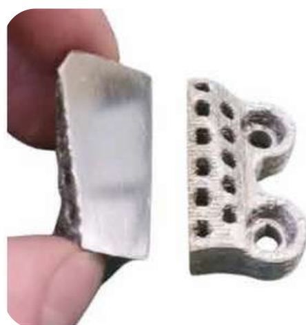
Кронштейн в разрезе, сталь 316L
