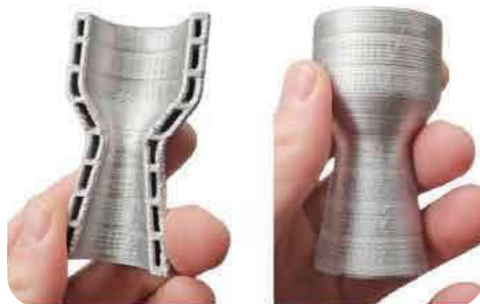
Сопло ракетного двигателя, сталь 316L
